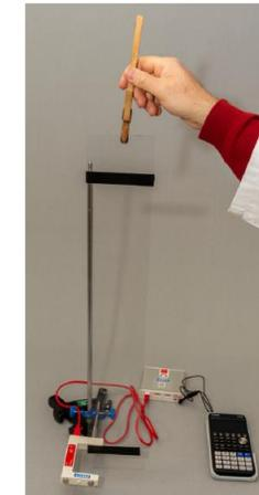
Figura 7 – Posição de largada da placa de acrílico.
