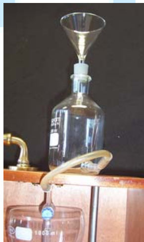
Pormenor do frasco de nível devidamente posicionado
