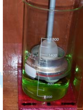
Pormenor do copo graduado instalado na sua base de centragem com a bóia descida
