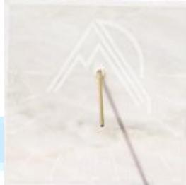
O modelo do relógio analemático deverá ser colocado no exterior, ao sol, em posição horizontal, com o eixo menor da elipse orientado no sentido Norte-Sul, de modo que a marca das 12 horas (meio-dia) fique do lado Norte (Ver em “Alguns recursos que pode consultar” – “Um relógio analemático na ESE de Setúbal”).
